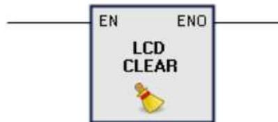
Agrega un componente que permite limpiar el texto de un display LCD.
